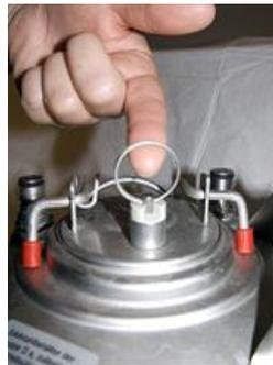
entfernen Sie den Bügel in der Mitte nach oben Druck steht, bekommen Sie Der Druck muss erst am Entlüftungsventil, in der ziehen und halten. Solange hören. Ist das Zischen nicht loslassen. Der Behälterdeckel
