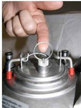
Getränkebehälters, entfernen den Bügel in der Mitte nach unter Druck steht, bekommen ab. Der Druck muss erst Ring am Entlüftungsventil, in oben ziehen und halten. Zischen zu hören. Ist das wieder loslassen. Der werden.
